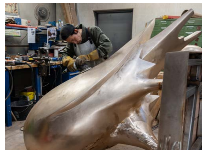
Oben: Der entscheidende Feinschliff : Die Oberfläche der Skulptur wird veredelt. Dafür muss sie zunächst geschliffen oder mit einem Sandstrahl bearbeitet werden.
