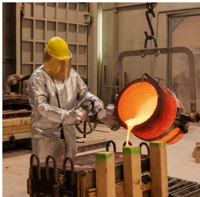
Oben: Der heiße Tiegel mit der flüssigen Bronze wird aus dem 1.200 Grad heißen Ofen geholt.
