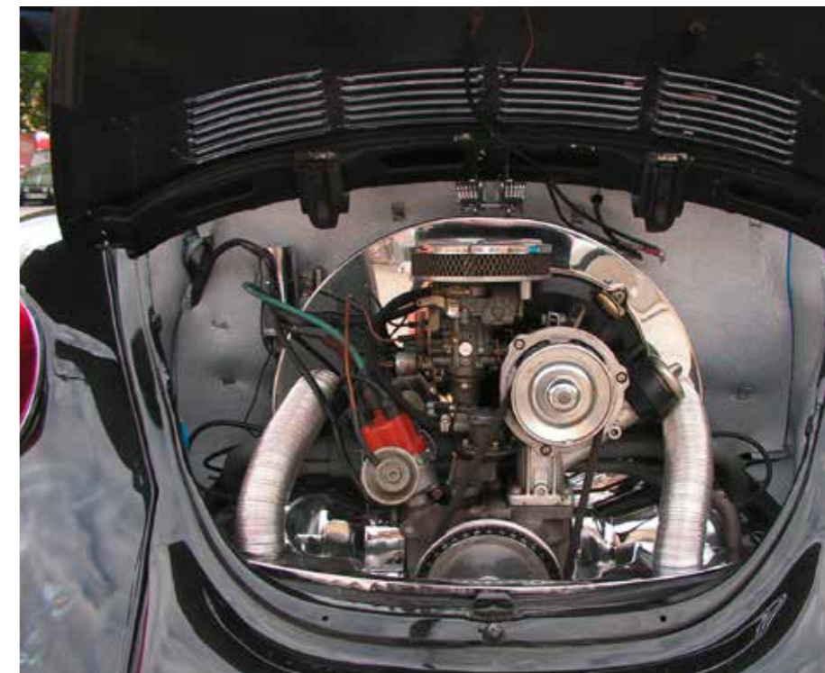
Eigens für den VW Käfer wurde in den 1930er Jahren der luftgekühlte Boxermotor mit vier Zylindern entwickelt.
